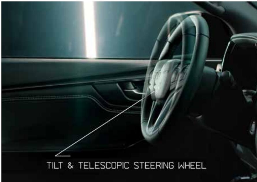
Réglage du volant en hauteur et en profondeur.
